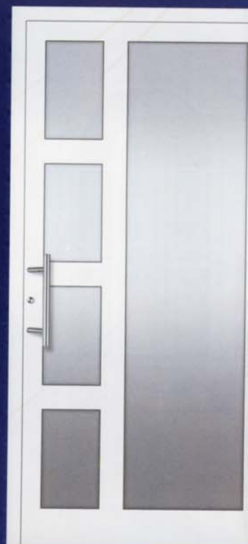
Modell 5502 U_D -Wert = 1,9 W/m^2K^* geteilte Sprossen 90 mm, Edelstahl-Stoßgriff 5722.350, Wärmeschutzisoliervlas, vorne: VSG beschichtet, hinten: Float, Mastercarre, Chinchilla weiß.
