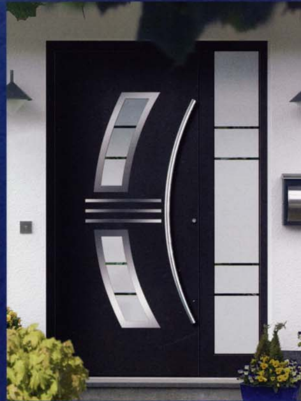
Modell 5204 U_D -Wert = 1,3 W/m^2K^* in flügelüberdeckend mit Seitenteil, Edelstahl-Stoßgriff 5806, vorne: VSG mattiert mit klaren Streifen, hinten: Float beschichtet, Applikationen nur außen. Seitenteil: vorne: VSG mattiert mit klaren Streifen, hinten: Float beschichtet. Oberfläche: RAL 7016 matt.
