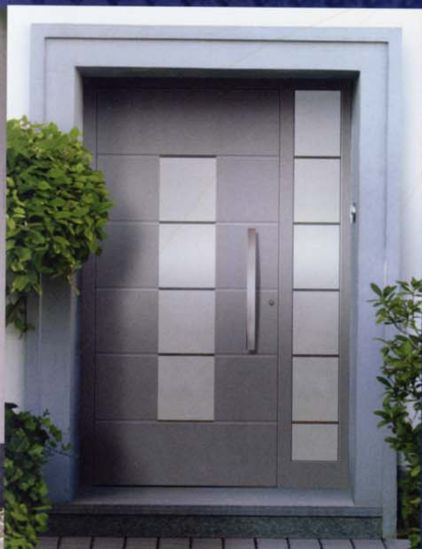
Modell 5326 Anwendungsbeispiel in flügelüberdeckend mit Seitenteil, Edelstahl-Stoßgriff 5805 auf Füllung montiert, vorne: VSG mattiert mit klaren Streifen, hinten: Float beschichtet, Nuten nur außen. Oberfläche: RAL 9007 matt.
