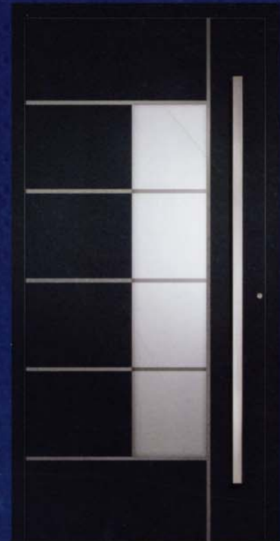
Modell 5332 U_D -Wert = 1,5 W/m^2K^* Edelstahl-Stoßgriff 5803 auf Füllung montiert, flügelüberdeckende Ausführung, vorne: VSG mattiert mit klarem Streifen, hinten: Float beschichtet, Nuten nur außen, Alunox eingelegt, flächenbündig. Oberfläche: DB 703 Metallic-Feinstruktur.
