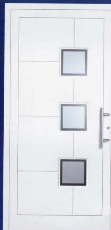
Modell 5323 U_D -Wert = 1,4 W/m^2K^* Edelstahl-Stoßgriff 5722.350, vorne: VSG mattiert mit klarem Rand, hinten: Float beschichtet, Nuten nur außen.
