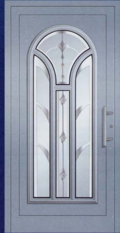
Modell 5121 U_D -Wert = 1,7 W/m^2K^* Edelstahl-Stoßgriff 5722.350, vorne: VSG beschichtet, hinten: Float teilmattiert mit Reliefgestaltung. Oberfläche: RAL 7001 matt.
