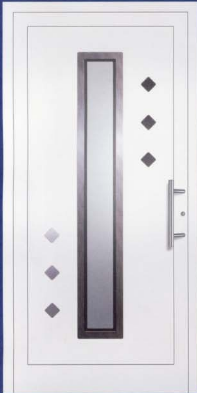
Modell 5203 U_D -Wert = 1,4 W/m^2K^* Edelstahl-Stoßgriff 5722.350, vorne: VSG mattiert mit klarem Rand, hinten: Float beschichtet alternativ vorne: VSG beschichtet, hinten: Float, Chinchilla weiß oder Mastercarre weiß. Applikationen nur außen.
