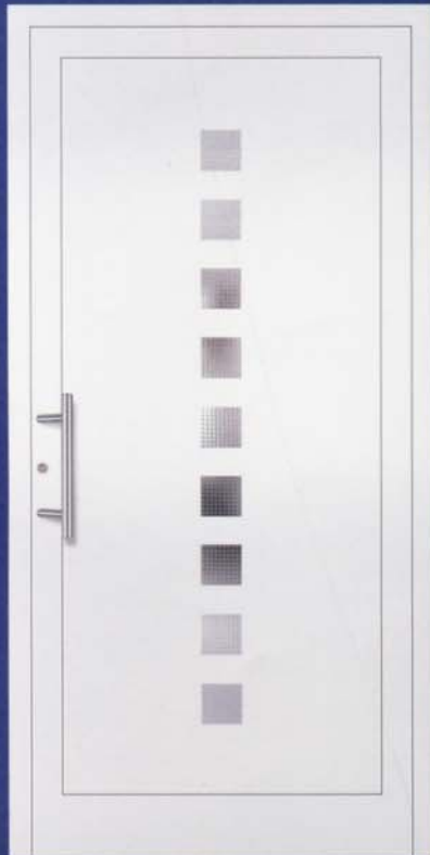
Modell 5412 U_D -Wert = 1,4 W/m^2K^* Edelstahl-Stoßgriff 5722.350, vorne: VSG vollflächig mattiert, hinten: Float beschichtet alternativ vorne: VSG beschichtet, hinten: Float, Chinchilla weiß oder Mastercarre weiß.
