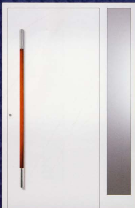
Modell 5415 U_D -Wert = 1,2 W/m^2K^* Anwendungsbeispiel in flügelüberdeckend, Edelstahl-Stoßgriff 5813.1600 mit Echtholz Jatoba auf Füllung montiert, komplett geschlossen, Seitenteil: vorne: VSG komplett mattiert, hinten: Float beschichtet.
