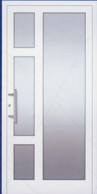
Modell 5505 U_D -Wert = 1,9 W/m^2K^* geteilte Sprossen 90 mm, Edelstahl-Stoßgriff 5722.350, Wärmeschutzisoliervglas, vorne: VSG beschichtet, hinten: Float, Mastercarre, Chinchilla weiß.
