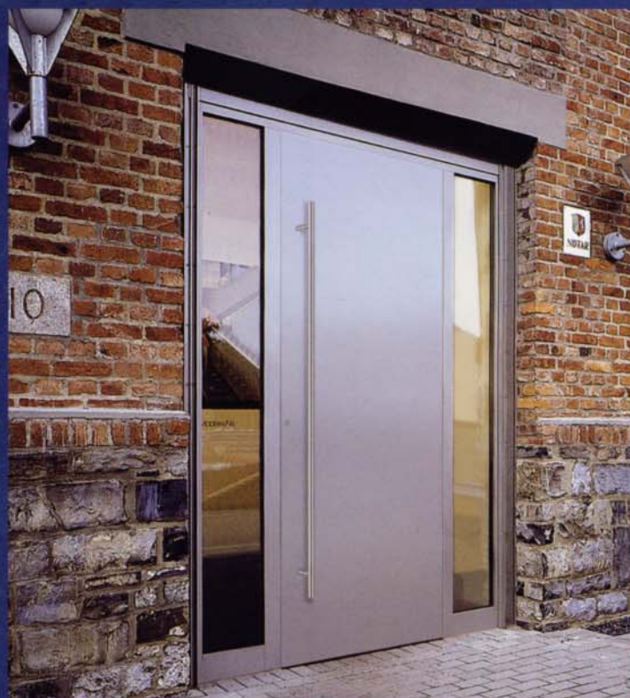
Modell 5415 Anwendungsbeispiel in flügelüberdeckender Ausführung, komplett geschlossen, mit zwei Seitenteilen, Edelstahl-Stoßgriff 5722.1800 mit geraden Stützen, Oberfläche: RAL 7004 matt.
