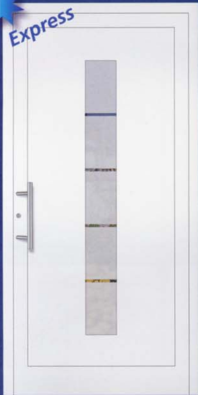
Modell 5405 U_D -Wert = 1,4 W/m^2K^* Edelstahl-Stoßgriff 5722.350, vorne: VSG mattiert mit klaren Streifen, hinten: Float beschichtet.
