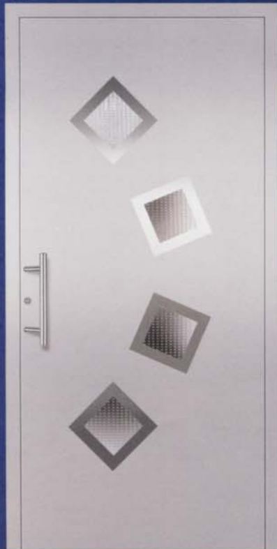
Modell 5211 U_D -Wert = 1,3 W/m^2K^* Anwendungsbeispiel flügelüberdeckend, Edelstahl-Stoßgriff 5722.350, vorne: VSG beschichtet, hinten: Mastercarre weiß. Oberfläche: RAL 9006 matt.
