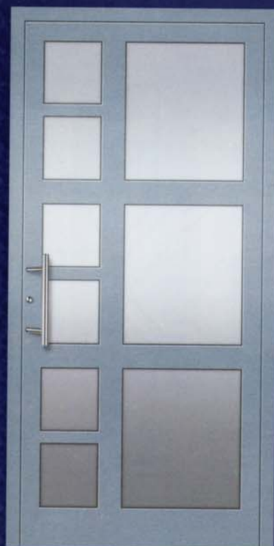
Modell 5501 U_D -Wert = 1,9 W/m^2K^* geteilte Sprossen 45 und 90 mm, Edelstahl-Stoßgriff 5722.350, Wärmeschutzisoliervlas, vorne: VSG beschichtet, hinten: Float, Mastercarre, Chinchilla weiß, Oberfläche: RAL 7001 matt.
