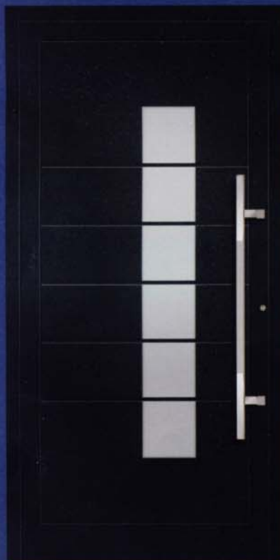
Modell 5318 U_D -Wert = 1,5 W/m^2K^* Edelstahl-Stoßgriff 5810, vorne: VSG mattiert mit klaren Streifen, hinten: Float beschichtet, Nuten nur außen. Oberfläche: Metallic-Feinstruktur DB 703.
