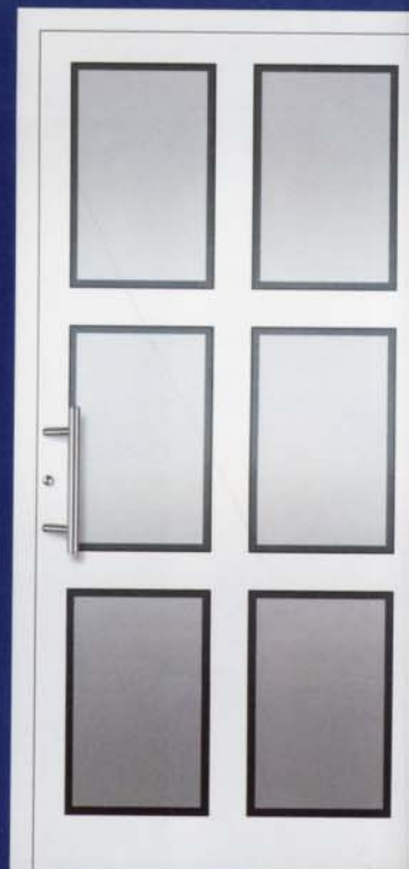
Modell 5511 U_D -Wert = 1,9 W/m^2K^* geteilte Sprosse 90 mm, Edelstahl-Stoßgriff 5722.350, Verglasung: Wärmeschutzisoliervlas, vorne: VSG mattiert mit klarem Rand, hinten: Float beschichtet.
