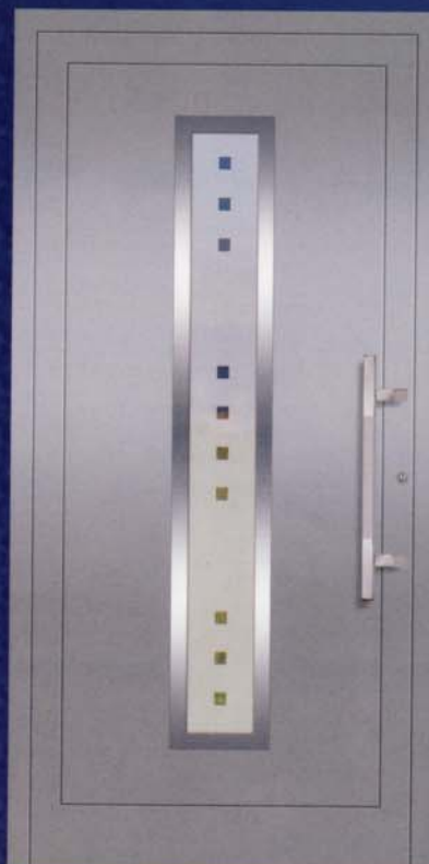
Modell 5217 U_D -Wert = 1,4 W/m^2K^* Edelstahl-Stoßgriff 5809, vorne: VSG mattiert mit klaren Quadraten, hinten: Float beschichtet. Oberfläche: RAL 9007 matt.
