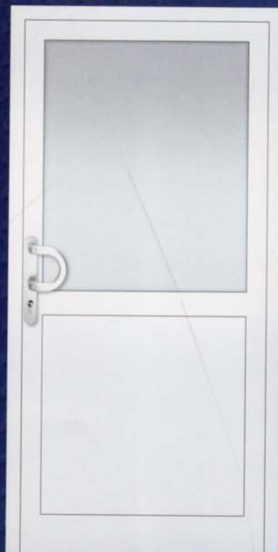
Modell 5506 U_D -Wert = 1,5 W/m^2K^* Nebeneingangstür mit nach unten versetzter Quersprosse mit Außengriffschild 5705, weiß Verglasung: Wärmeschutzisoliervlas VSG / Float oder VSG beschichtet mit Chinchilla, Ornament 187 oder 523 weiß, unten wärmedämmtes Alu-Sandwich-Paneel, glatt.
