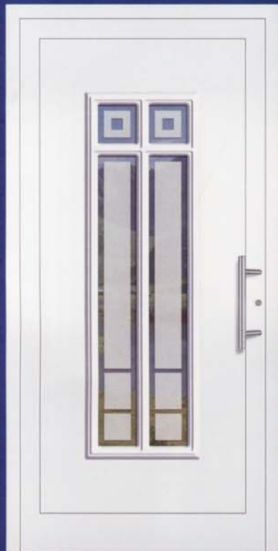
Modell 5123 U_D -Wert = 1,5 W/m^2K^* Edelstahl-Stoßgriff 5722.350, vorne: VSG mattiert mit klarem Rand, Streifen und Quadraten, hinten: Float beschichtet.
