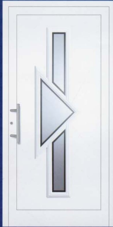
Modell 5105 U_D -Wert = 1,5 W/m 2 K* Edelstahl-Stoßgriff 5722.350, vorne: VSG mattiert mit klarem Rand, hinten: Float beschichtet alternativ vorne: VSG beschichtet, hinten: Float, Chinchilla weiß oder Mastercarre weiß.
