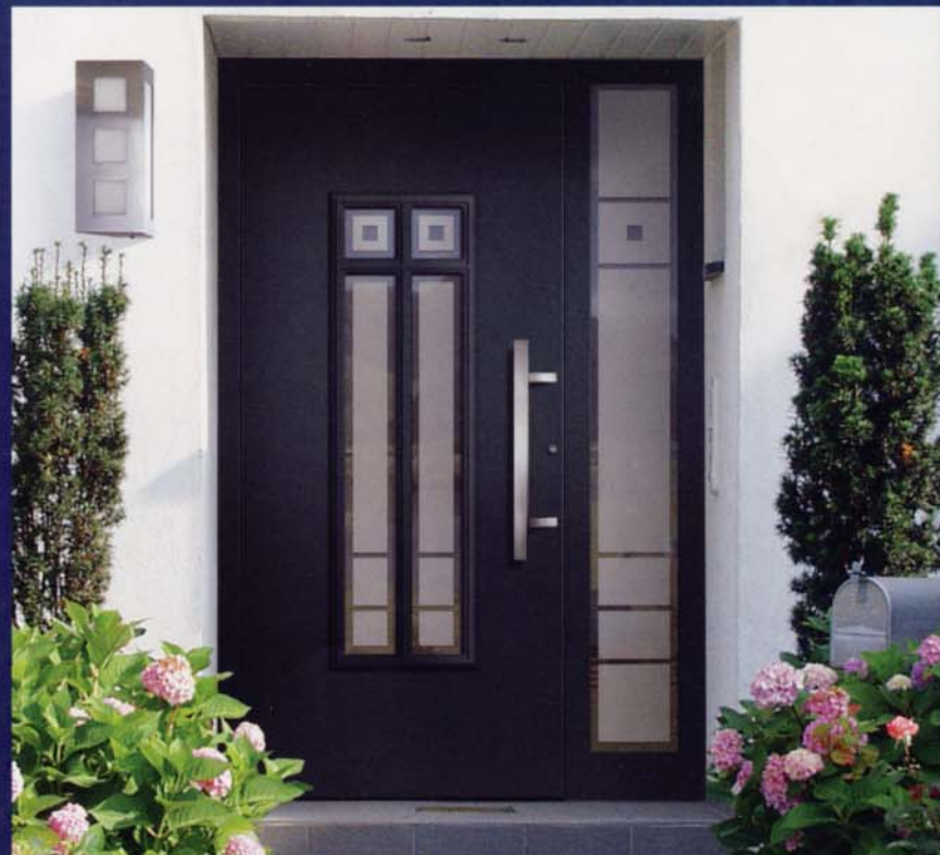
Modell 5123 in flügelüberdeckender Ausführung, Edelstahl-Stoßgriff 5803, vorne: VSG mattiert mit klarem Rand, Streifen und Quadraten, hinten: Float beschichtet. Seitenteil mit passender Verglasung. Oberfläche: RAL 7016 matt.
