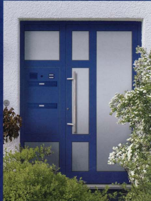
Modell 5505 Anwendungsbeispiel mit Seitenteil und Briefkastenanlage, geteilte Sprosse 90 mm, Edelstahl-Stoßgriff 5798.800, Verglasung: Wärmeschutzisoliervglas, vorne: VSG beschichtet, hinten: Float, Mastercarre, Chinchilla weiß. Oberfläche: RAL 5005 matt.
