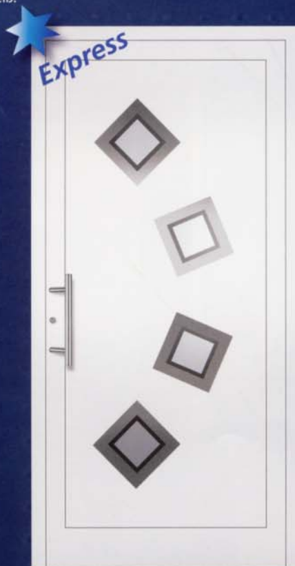
Modell 5211 U_D -Wert = 1,4 W/m^2K^* Edelstahl-Stoßgriff 5722.350, vorne: VSG mattiert mit umlaufend klarem Rand, hinten: Float beschichtet alternativ vorne: VSG beschichtet, hinten: Float, Chinchilla weiß oder Mastercarre weiß.
